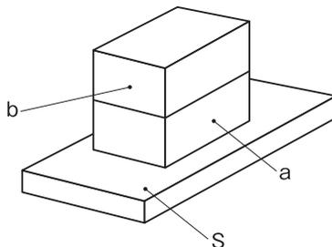
延べ面積とは、建築物の各階の床面積の合計です。各階の床面積は各階の壁・柱等の区画の中心線で囲まれた部分の面積です（施行令第2条）。
