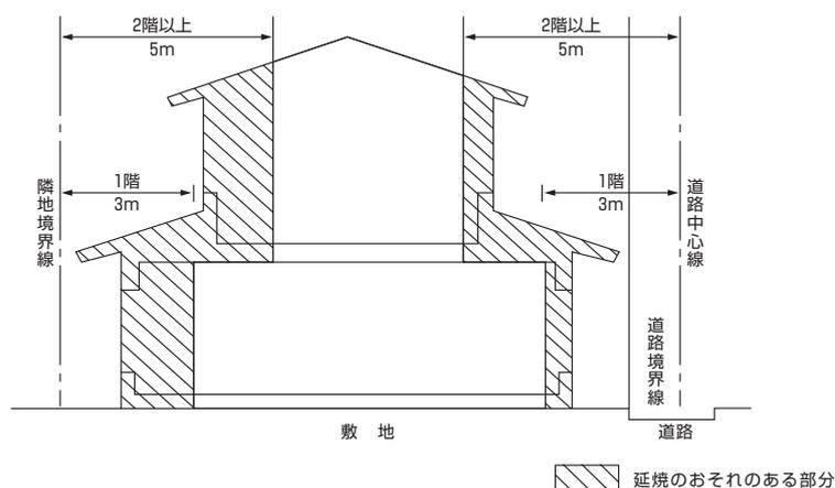
「隣地境界線、道路中心線又は同一敷地内の2以上の建築物（延べ面積の合計が500㎡以内の建築物は、一の建築物とみなす）相互の外壁間の中心線から1階にあっては3m以下、2階以上にあっては5m以下の距離にある建築物の部分です。ただし、防火上有効な公園、広場、川等の空地若しくは水面又は耐火構造の壁その他これらに関するものに面する部分を除きます。」
