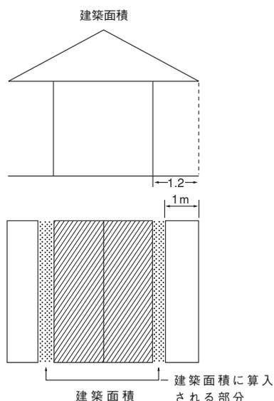
建築面積とは建築物の外壁・柱の中心線で囲まれた部分の面積です。ただし、軒、ひさし、バルコニー等でこの中心線より1m以上突き出た所があるときは、先端より1m後退した部分までは建築面積に算入されず（施行令第2条）。
