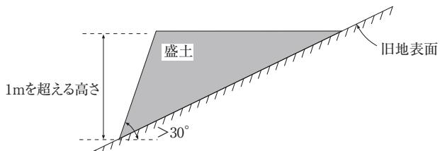
III 切土と盛土とを同時にする場合における盛土であって、当該盛土をした土地の部分に高さが1m以下の崖を生じ、かつ、当該切土及び盛土をした土地の部分に高さが2mを超える崖を生ずることとなるもの（図3）。
